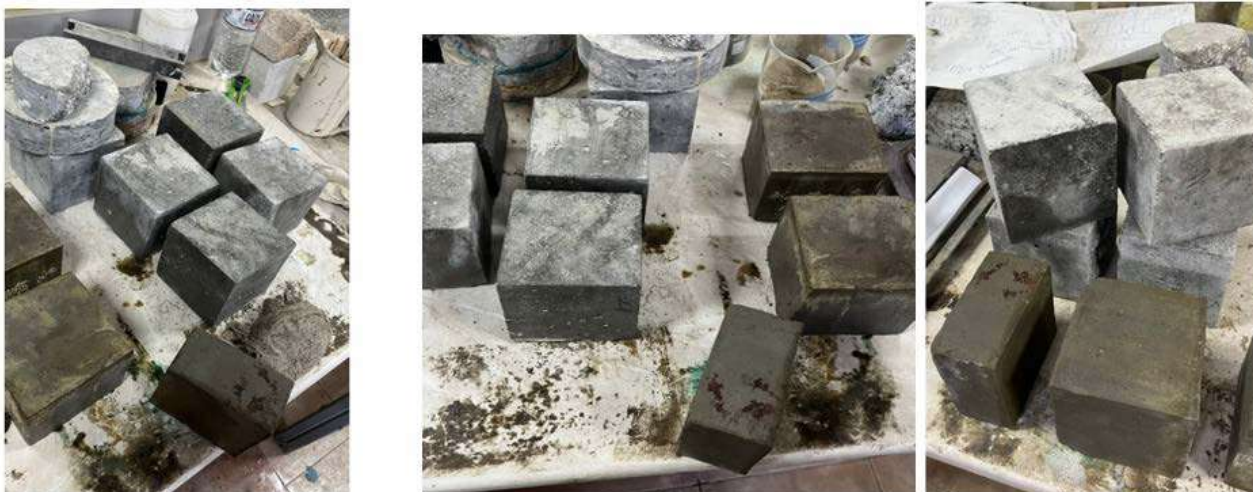
Рис. 41-43. Образцы СУБ-бетона с добавкой микрокремнезема и золы, с использованием поликарбоксилатных суперпластификаторов и суперпластификатора СЗ.
