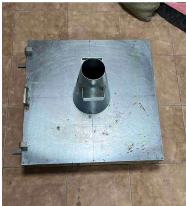
Рис. 1. Конус для определения подвижности бетонной смеси и металлический лист.
