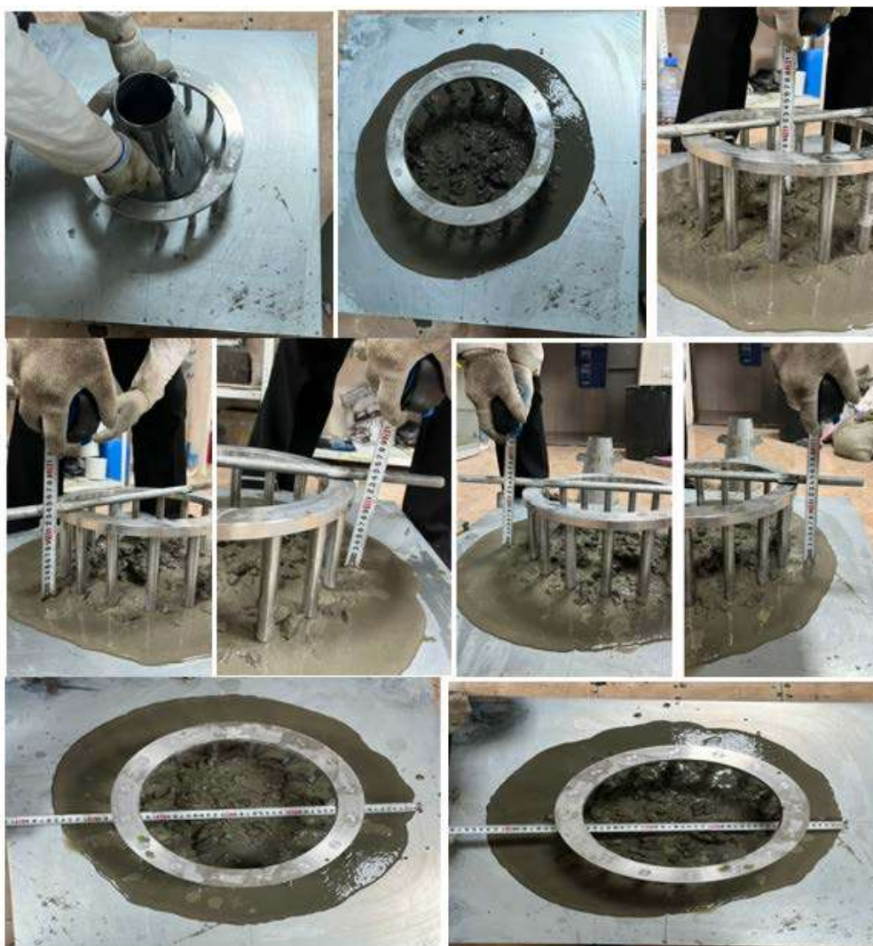
Рис. 23-31. Испытание для определения текучести, СУБС с поликарбоксилатом и МК-25%.
