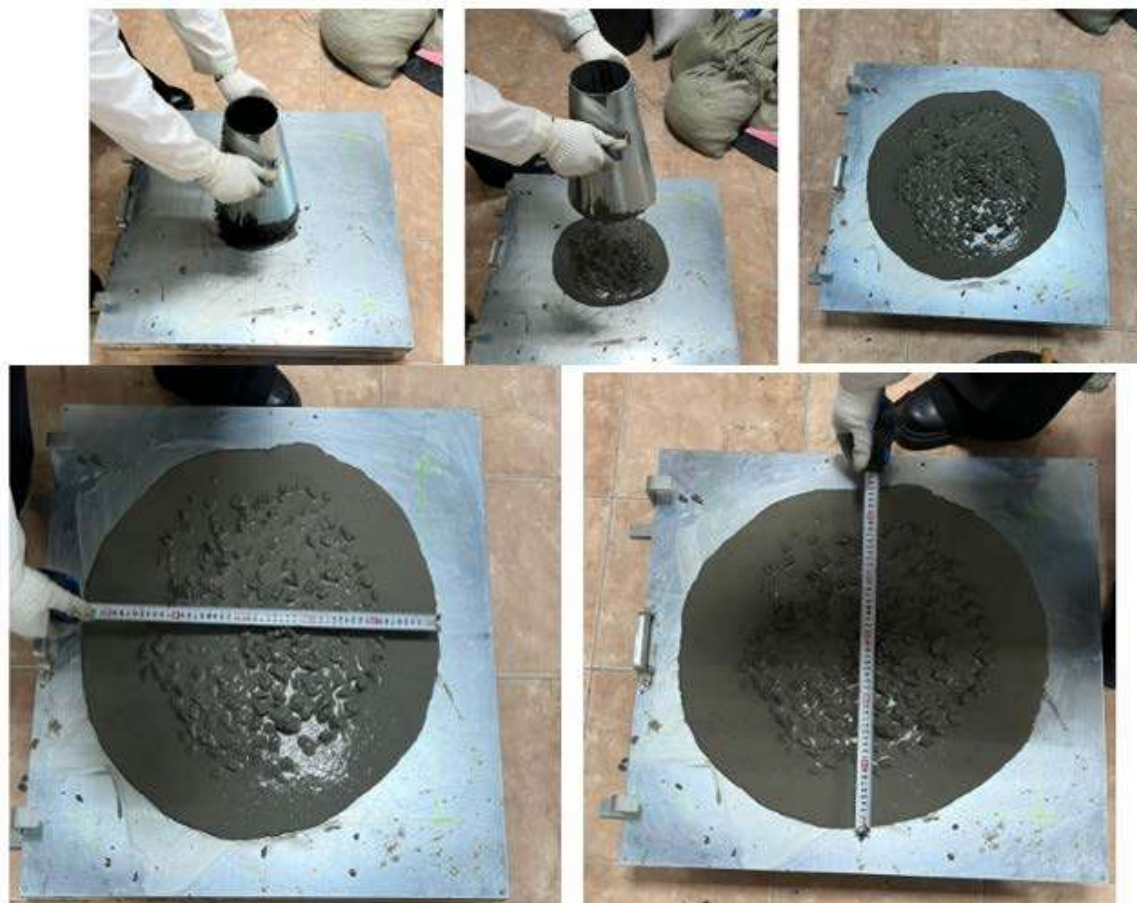
Рис. 2-6. Испытание для определения удобоукладываемости и скорости расплыва самоуплотняющейся бетонной смеси СУБС с поликарбонатом и МК-10%.
