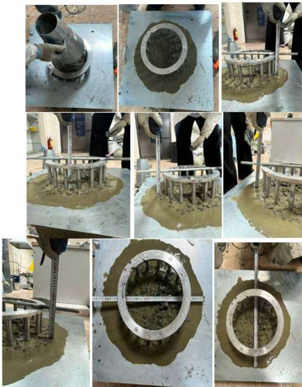
Рис. 32-40. Испытание для определения текучести, СУБС с суперпластификатором С-3 и золой-30%.
