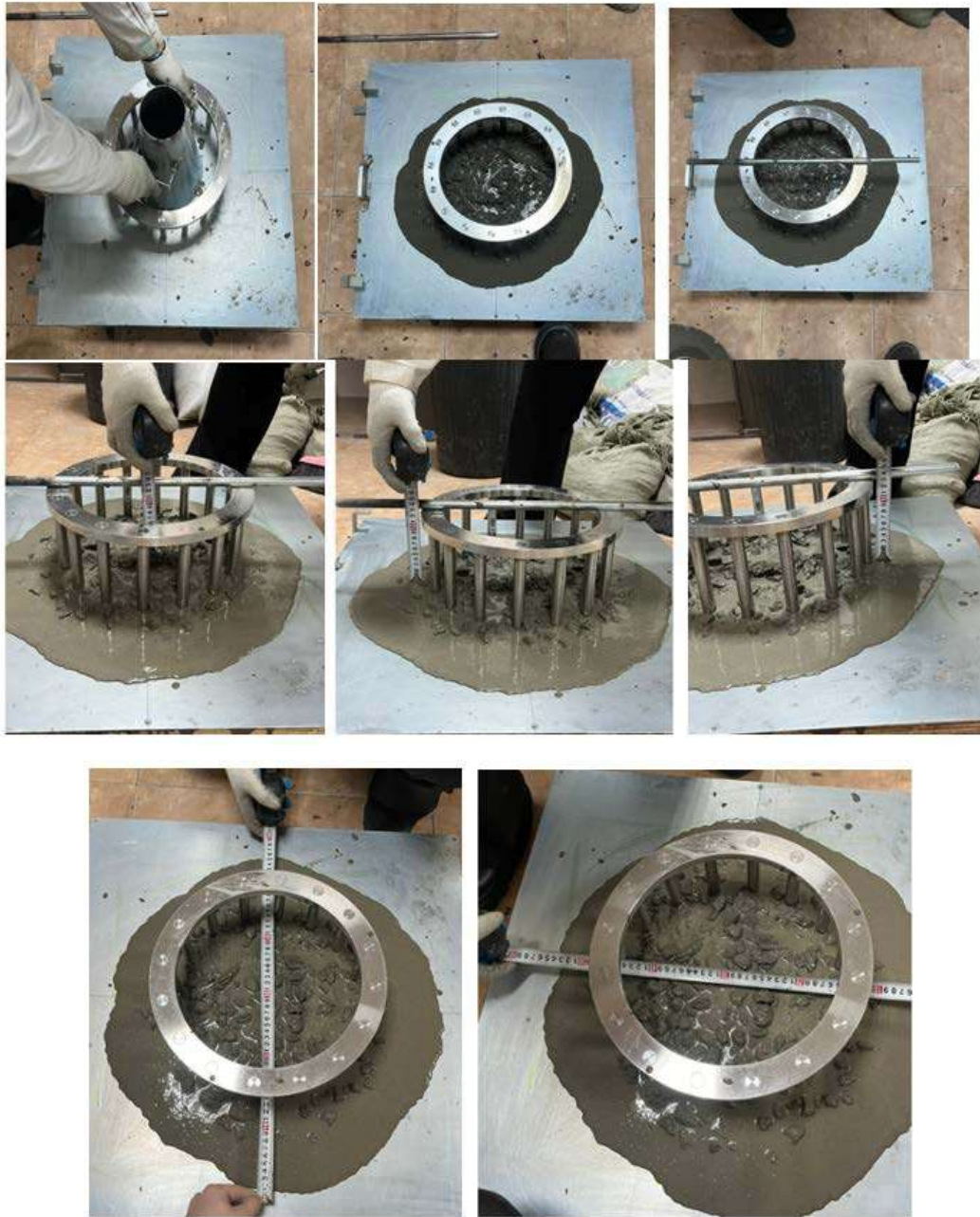
Рис. 15-22. Испытание для определения текучести, СУБС с поликарбонатом и МК-10%.
